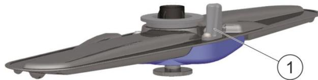
6. Damit der Sensor die Drehung des Spülarms erkennt, alle Schmutzpartikel und eisenhaltige Partikel, die am Magneten (1) haften, entfernen.
