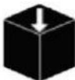
Beim Drücken der zugehörigen Bestätigungstaste oben rechts wird das Symbol **Haube schließen** im Display angezeigt, der Bediener kann nun innerhalb von 10 Sekunden die Haube ohne Programmstart schließen. Danach muss die Taste erneut betätigt werden. Ggf. laufende i-Menü Sitzungen müssen vorher mit der Service-Zugangstaste beendet werden, siehe Seite 42!
