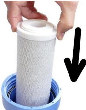
5. Den von innen und außen abgespülten neuen Filtereinsatz einsetzen. Korrekten Sitz der Dichtungen prüfen.
