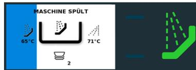
Die Spülmaschine spült selbsttätig und schaltet das Programm nach Beendigung ab. Der Programmfortschritt wird auf dem Display angezeigt.
