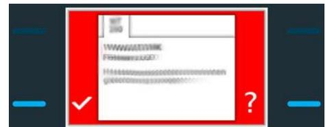
Bei Auftreten einer Störung werden im Display je nach Störungsart, graue oder rote Meldungen angezeigt.
